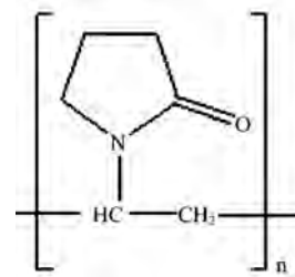
图 3 聚乙烯吡咯烷酮(PVP)的分子结构式 Fig.3 The structural formula of Polyvinylpyrrolidone (PVP)
