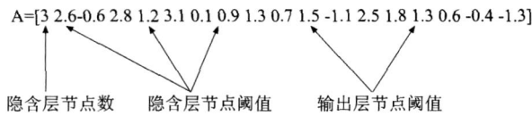
图1 染色体编码 Fig.1 Chromosome code
