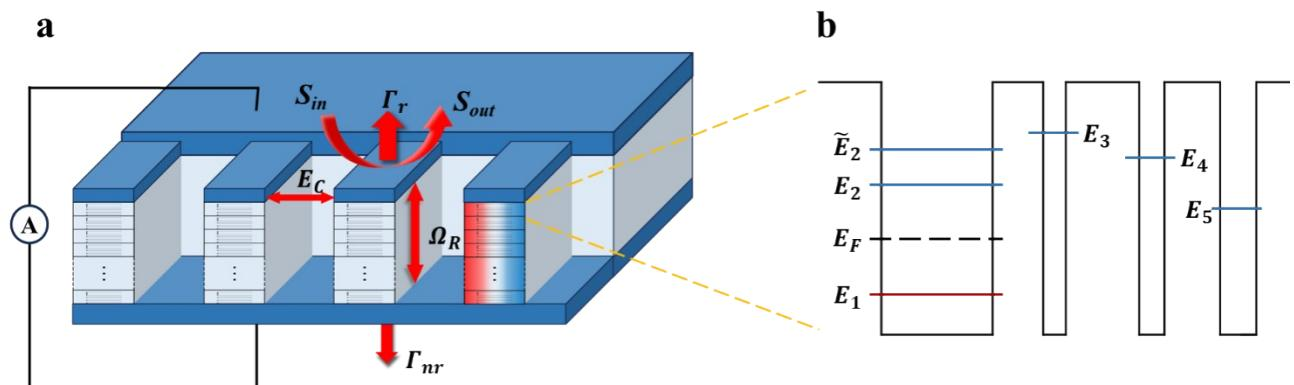
图1 谐振腔光电探测器装置与能级分布示意图:(a) 装置示意图:输入光场 $S_{in}$ 和输出光场 $S_{out}$ 。辐射耗散系数 $\Gamma_r$ 和非辐射耗散系数 $\Gamma_{nr}$ 。腔模电场 $E_c$ 和真空拉比频率 $\Omega_R$ 。(b) 能级分布示意图:基础能级 $E_1$ 、第一激发态 $E_2$ 、集体激发电子能级 $\tilde{E}_2$ 、费米能级 $E_F$ 和提取能级 $E_3$ 。
