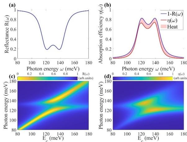
图2 光电探测器的反射率和吸收效率:(a) 在  $E_c = 130 \text{ meV}$ ,  $g = \Omega_r \approx 11 \text{ meV}$ ,  $\omega_{31} = 141 \text{ meV}$  条件下的反射谱线;(b) 在相同条件下的吸收率谱线,着色部分为  $\Delta(\omega)$ ,蓝色线为  $1 - R(\omega)$ ,红色线为  $\eta(\omega)$ ;(c) 改变腔模频率  $E_c$  计算得到的反射谱映射;(d) 改变腔模频率  $E_c$  计算得到的吸收率映射图。
