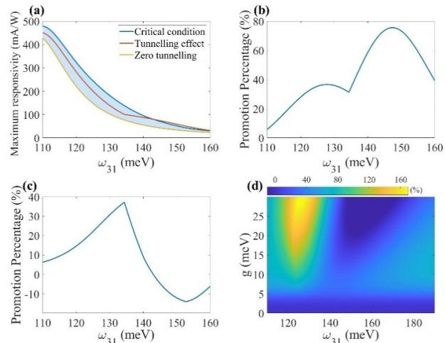
图4 光电响应最大值与隧穿效应及临界耦合条件的关系分析:(a)  $g = 11 \text{ meV}$  时,不同条件下光电响应率最大值随提取能级  $\omega_{31}$  的变化:蓝色实线表示考虑隧穿效应并满足临界耦合条件的结果,橙色实线表示仅考虑隧穿效应的结果,红色实线表示忽略隧穿效应的结果;(b) 考虑隧穿效应相对于未考虑隧穿效应的光电响应率提升百分比;(c) 新临界耦合条件相对于仅考虑隧穿效应的光电响应率提升百分比;(d) 改变耦合强度  $g$ ,本文临界耦合条件相对于常规临界耦合条件的光电响应率提升百分比的热图。
