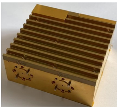
图 14 220 GHz 集成收发组件实物图
