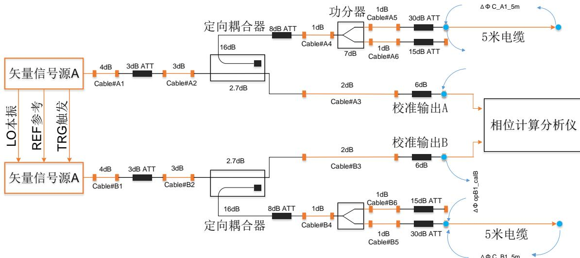
图9 相参信号输出相位差校正
