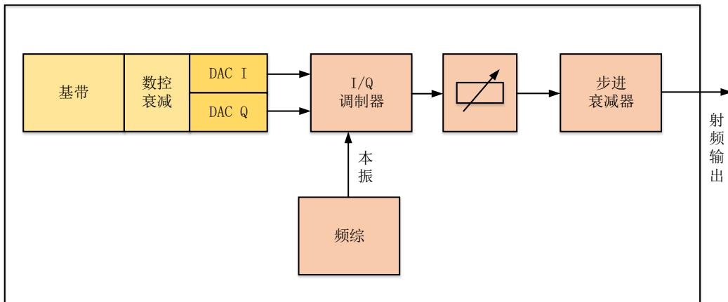
图2 矢量信号源内部原理图
