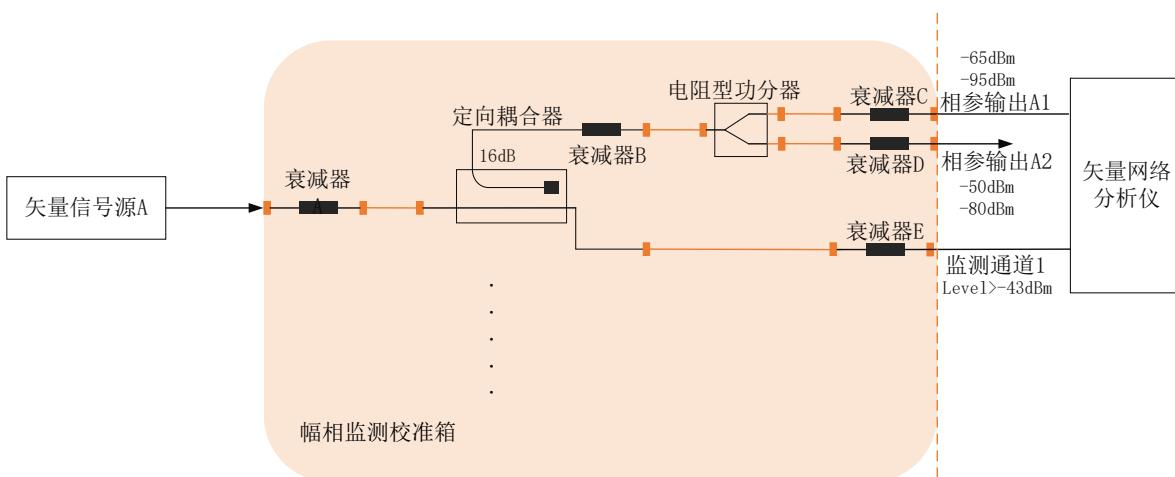
图6 校准口与相参输出口的固有矢量差的校准数据示意图
