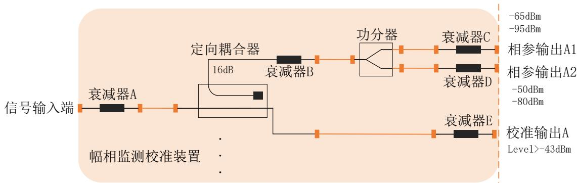
图5 矢量监测校准输出网络工作原理图
