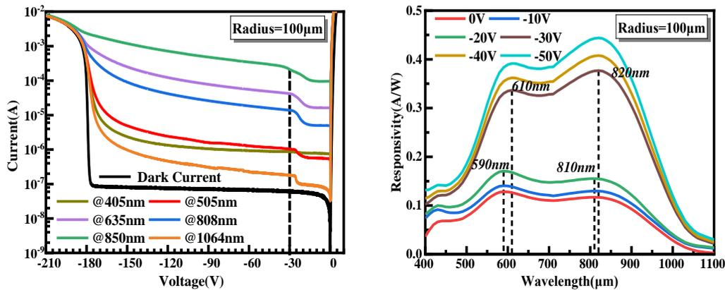
图4 (a)器件在不同波长下的光电流 (b)器件在不同偏压下的光谱响应
