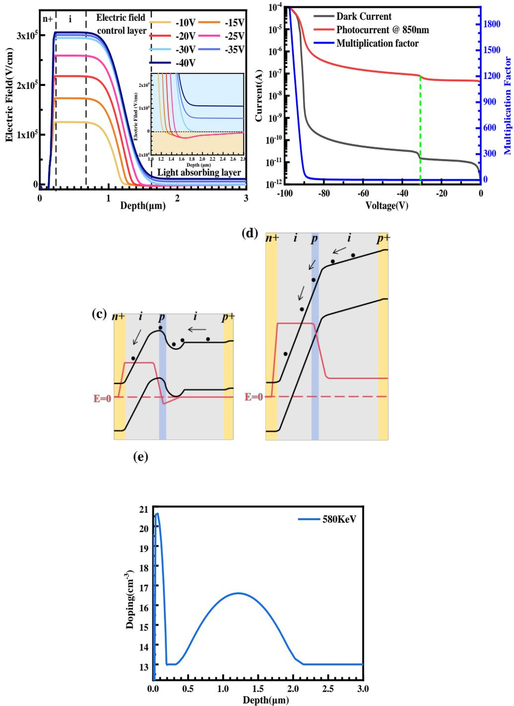
图 2(a) 不同反向偏压下,器件内部电场仿真图 (b) SACM APD 的仿真 I-V 特性和倍增系数 (c) 器件穿通前能带示意图 (d) 穿通后能带示意图 (e) 离子注入能量为 580KeV 时器件掺杂浓度示意图
