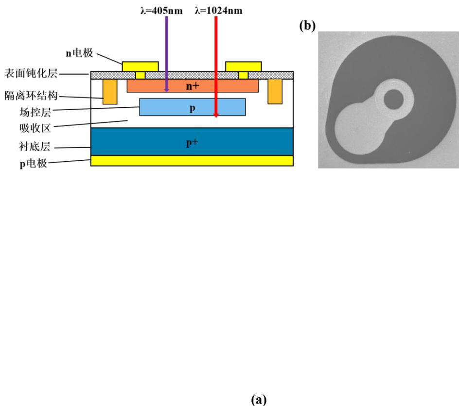
图 1(a) SACM APD 结构剖视图 (b) 器件 SEM 图
