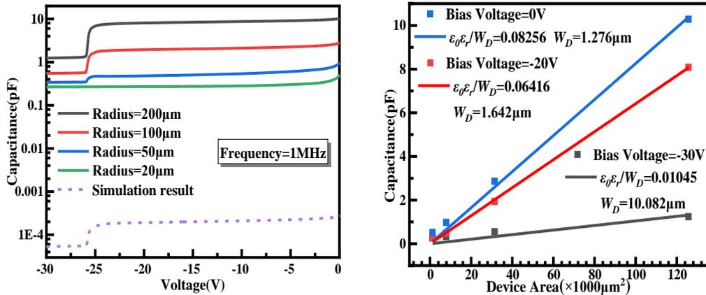
图5 (a)不同频率下100 $\mu\text{m}$  SACM APD的C-V特性 (b)1MHz下不同光敏面半径SACM APD的C-V特性(虚线为半径100 $\mu\text{m}$ 器件在1MHz频率下电容仿真曲线)(c)不同尺寸器件在0V、-20V、-30V偏压下的电容值及电容与器件光敏面面积拟合关系
