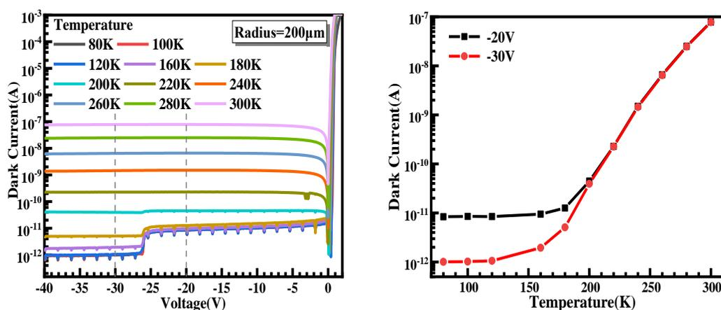
图 6 (a)不同温度下200μm SACM APD的暗电流特性:(b)不同偏压下器件暗电流随温度的变化关系
