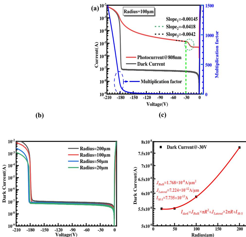
图3(a)  $100\mu\text{m}$  SACM APD的I-V特性和倍增系数 (b)光敏面半径 $20\mu\text{m}$ 、 $50\mu\text{m}$ 、 $100\mu\text{m}$ 、 $200\mu\text{m}$ 器件暗电流曲线(c)不同半径器件在偏置电压为 $-30\text{V}$ 时的暗电流拟
