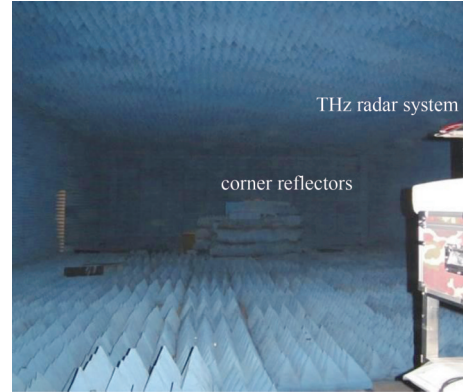
Fig. 4 Experimental scenario of 0.22 THz radar imaging 图4 0.22 THz 雷达实验系统
