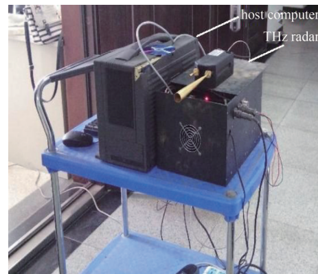
Fig. 8 A photograph of the 0.22 THz radar system 图8 0.22 THz 雷达
