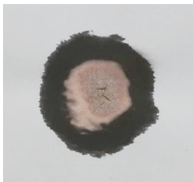
图15 热敏纸获得的输出微波束斑
