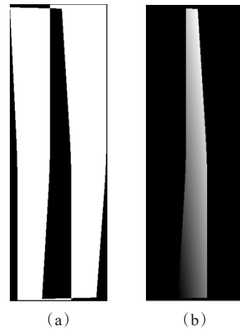
图10 本文融合阶段结果(a)左右两幅影像mask (b)重叠区域融合系数图
