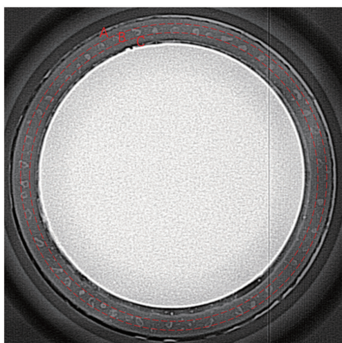
图 7 预涂覆 SAC305 焊环在 4 gf 焊接压力下的窗口 X 射线图像
