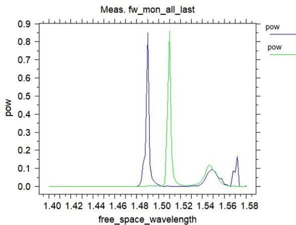
图4 初始模型的滤波性能仿真
