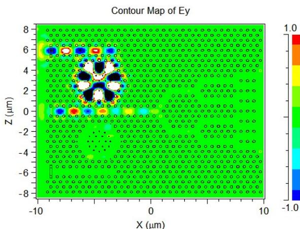
图9  $1.490 \mu\text{m}$  波长滤波结构光场分布
