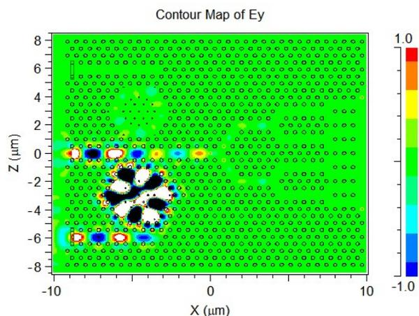
图10 1.510 μm波长滤波结构光场分布
