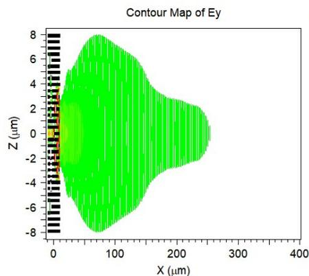
图8 1.462  $\mu\text{m}$ 的出射光集束仿真
