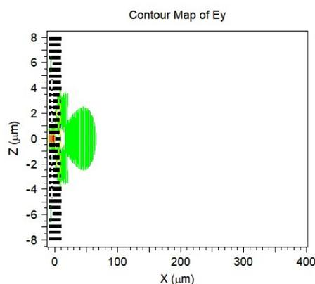
图7 1.440  $\mu\text{m}$ 的出射光集束仿真
