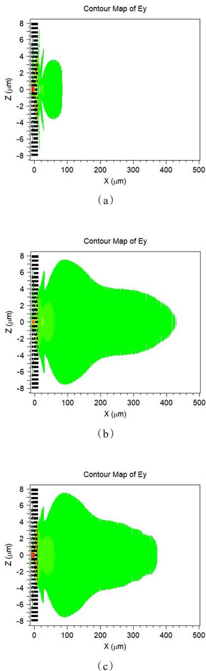
图6 优化后结构的出射光集束仿真:(a) 6个介质柱;(b) 2个介质柱;(c) 0个介质柱
