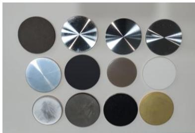
图4 杜瓦材料发射率测试样品
