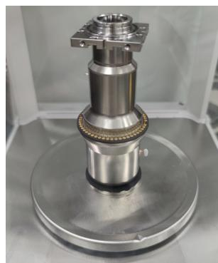
图 11 杜瓦热负载测试
