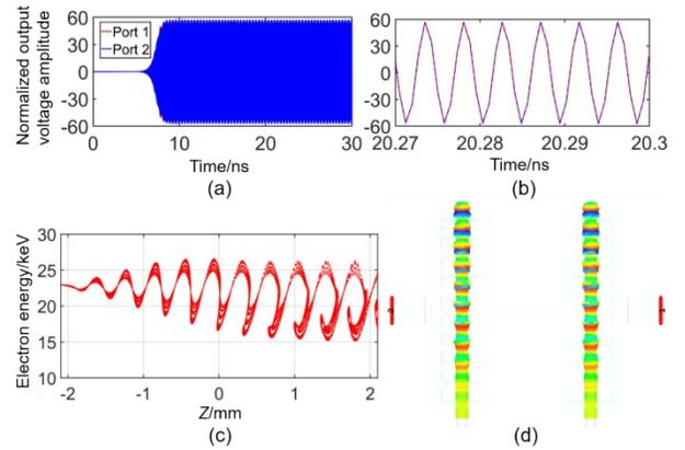
图8 当耦合桥长为  $L_{g1}$  的锁相振荡器被电压 23 kV 下具有相同注电流 0.6 A 的双电子注驱动时,该图表示(a)两个端口的输出信号;(b)用于显示相位差的 20.27 ns 到 20.3 ns 之间信号的详细信息;(c)双注电子的相空间图;(d)双注电子的轨迹
