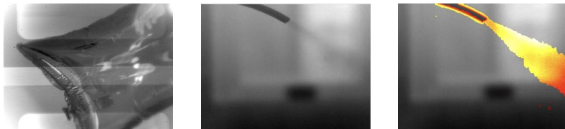
图 10 乙烯气体最低检测浓度成像实验
