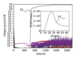
Fig. 4 The startup of multi-mode beam-wave interaction, where the beam voltage of 40 kV, beam current of 4A, transverse-to-axial velocity ratio of 1.3, beam radius of 3.3 mm 图 4 多模式注波相互作用的起振,其中电子注电压为 40 kV, 电子注电流为 4 A, 横轴速度比为 1.3, 电子注半径为 3.3 mm
