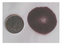
Fig. 9 The field pattern on a piece of paper at 0. 6m from the gyrotron output window图 9 距回旋管输出窗口 0.6m的热敏纸上的场模式分布
