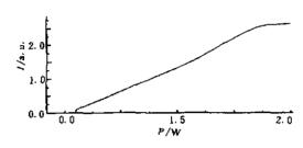
图 5 Nd3+: YAG 小球 1036.5nm 处的费 光峰输出光强与泵浦功率之间的关系 pumping power at 1036.5nm peak of fluorescent spectrum of Nd3+ : YAG microsphere
